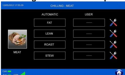
La colonne de gauche liste 4 programmes automatiques, selon les propriétés de l'aliment. Lors de la sélection de ces programmes, il n'est pas nécessaire de saisir d'autres paramètres. Il suffit d'insérer la sonde d'aliments.
