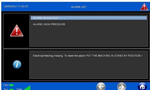
**Affichage des alarmes** : cette icône apparaît lorsque la machine se met en alarme. Pour désactiver l'alarme sonore, appuyer sur l'icône.
