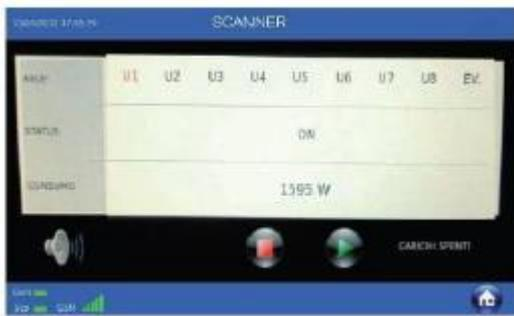
Cette fonction permet de vérifier si les composants sont actifs et correctement raccordés. Pour exécuter les différents composants, appuyer sur la touche « PLAY » et attendre que la valeur associée « Ux » devienne rouge, que l'état « ON » ainsi que la consommation de l'élément testé s'affichent en watts.
