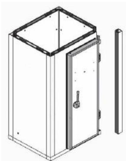
Im letzten Schritt befestigen Sie das Dach und bringen die Bohrungsabdeckungen an.
