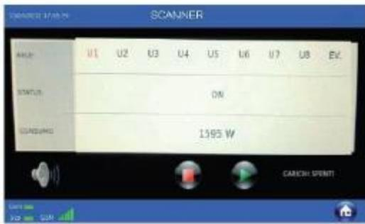
Diese Funktion dient zur Überprüfung, ob die Komponenten aktiv und korrekt verbunden sind. Zur Durchführung der einzelnen Komponenten drücken Sie die Taste „PLAY“ und warten Sie, bis sich der dazugehörige Wert „Ux“ rot färbt, der Status „ON“ und der Verbrauch des geprüften Elements in Watt angezeigt wird.
