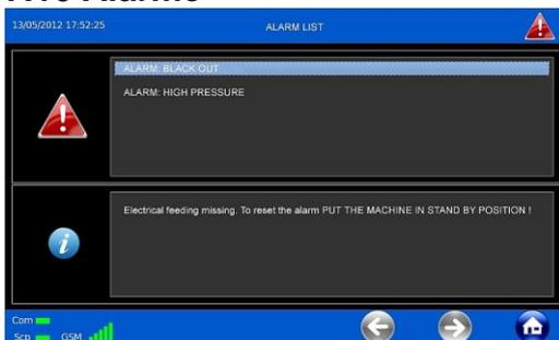
**Alarmanzeige:** Dieses Symbol erscheint, wenn die Maschine in Alarm geht. Um den Alarm stumm zu schalten, muss das Symbol gedrückt werden.
