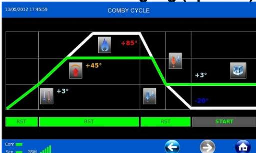
**ACHTUNG:** Bei den Durchgängen Slow Cooking und Gärung empfehlen wir, eine Ventilation = 1, bei Auftauvorgängen eine Ventilation = 10 einzugeben.
