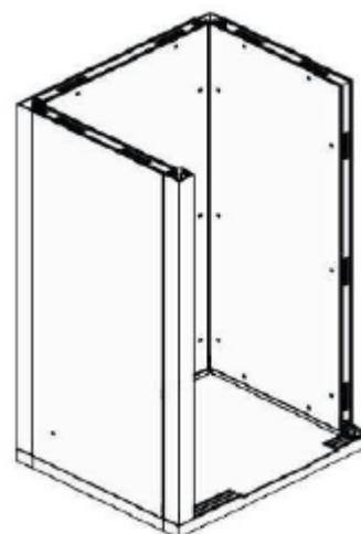
Befestigen Sie die Türpaneele. Schließen Sie die Tür mit dem vorderen Träger.
