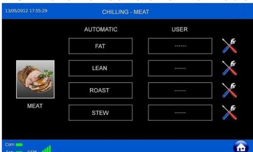
In der linken Spalte sind 4 automatische Programme aufgelistet, je nach Eigenschaften des Lebensmittels. Bei Auswahl dieser Programme muss kein sonstiger Parameter eingegeben werden. Es genügt, einfach die Lebensmittelsonde einzuführen.
