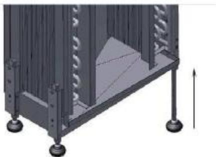
Stellen Sie den Verdampfer mit komplett eingedrehten Füßen in die Zelle. Danach schweißen Sie die Verlängerungsrohre an.
