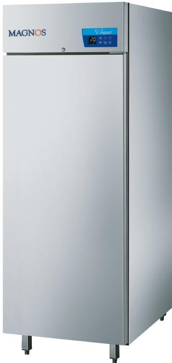
Tiefkühlschrank, innen und außen aus CNS (1.4301 / AISI 304), Hygieneausführung, mit Umluftkühlung und selbstschließender Tür, abschließbar. Verdampfer ausserhalb des Kühlinnerenraumes. Elektronische Regelung mit automatischem ECO-Modus, bedarfsgerechter Abtau- und Lüftersteuerung und beleuchtetem 3 Zoll LCD-Display. Auch zur Verwendung von GN1/1 geeignet.
