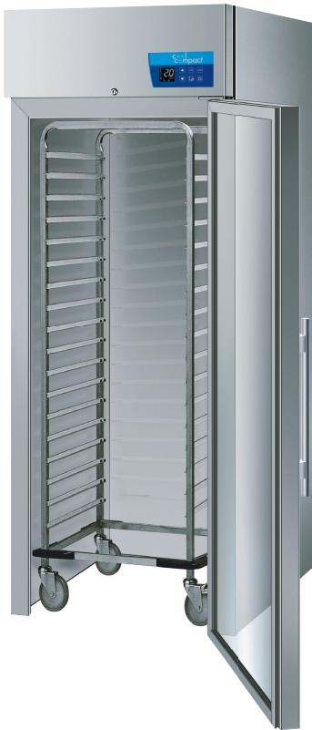
Einfahr-Kühlschrank mit Glastüre, ohne Boden, mit CNS (1.4301 / AISI 304) Montagerahmen, innen und außen aus CNS (1.4301 / AISI 304), Hygieneausführung, Verdampfer außerhalb des Kühl-Innenraumes, mit Umluftkühlung.
