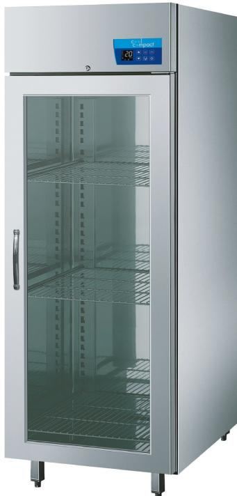
Kühlschrank mit Glastüre, innen und außen aus CNS (1.4301 / AISI 304), Hygieneausführung, mit Umluftkühlung und selbstschließender Tür, abschließbar. Verdampfer außerhalb des Kühlinnerenraumes. Elektronische Regelung mit automatischem ECO-Modus, bedarfsgerechter Abtau- und Lüftersteuerung und beleuchtetem 3 Zoll LCD-Display. Auch zur Verwendung von GN1/1 geeignet.
