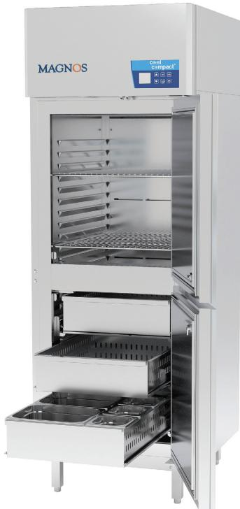
Kühlschrank mit zwei Türen, und drei Zügen, innen und außen aus CNS (1.4301 / AISI 304), Hygieneausführung, Verdampfer außerhalb des Kühl-Innenraumes, mit Umluftkühlung und selbstschließender Tür, abschließbar. Elektronische Regelung mit automatischem ECO-Modus, bedarfsgerechter Abtau- und Lüftersteuerung und beleuchtetem 3 Zoll LCD-Display.
