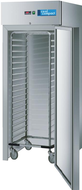
Einfahr-Wärmeschrank ohne Boden, mit CNS (1.4301 / AISI 304) Montagerahmen, innen und außen aus CNS (1.4301 / AISI 304), Hygieneausführung, Heizregister außerhalb des Innenraumes und elektronischer Regelung.
