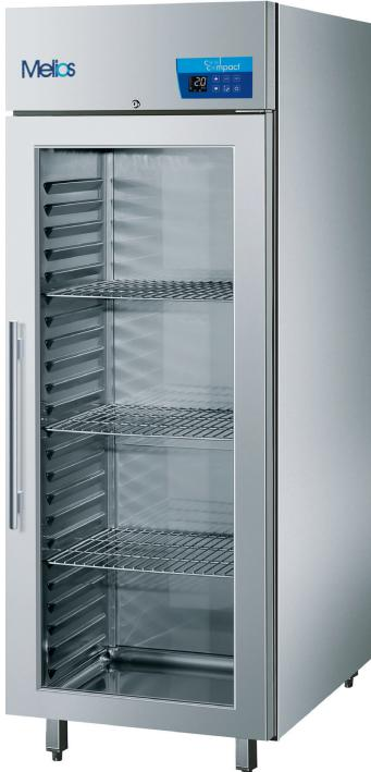
Kühlschrank mit Glastüre, innen und außen aus CNS (1.4301 / AISI 304), Hygieneausführung, Verdampfer außerhalb des Kühl-Innenraumes, mit Umluftkühlung und selbstschließender Tür, abschließbar. Elektronische Regelung mit automatischem ECO-Modus, bedarfsgerechter Abtau- und Lüftersteuerung und beleuchtetem 3 Zoll LCD-Display. 90 mm Isolation, Innenraum mit Auflagerippen, frei von Stell- und Auflageschienen, tiefgezogene Bodenwanne mit Hygieneradien.
