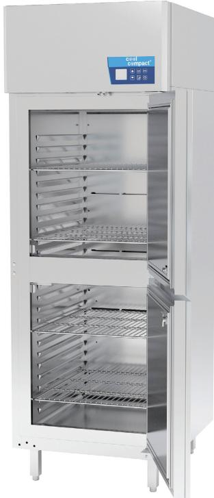
Tiefkühlschrank mit 2 Türen, innen und außen aus CNS (1.4301 / AISI 304), Hygieneausführung, Verdampfer außerhalb des Kühl-Innenraumes, mit Umluftkühlung und selbstschließender Tür, abschließbar. Elektronische Regelung mit automatischem ECO-Modus, bedarfsgerechter Abtau- und Lüftersteuerung und beleuchtetem 3 Zoll LCD-Display.
