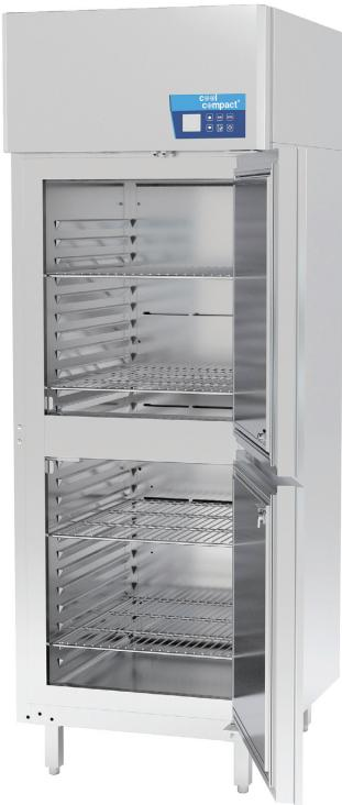
Kühlschrank mit zwei Türen, innen und außen aus CNS (1.4301 / AISI 304), Hygieneausführung, Verdampfer außerhalb des Kühl-Innenraumes, mit Umluftkühlung und selbstschließender Tür, abschließbar. Elektronische Regelung mit automatischem ECO-Modus, bedarfsgerechter Abtau- und Lüftersteuerung und beleuchtetem 3 Zoll LCD-Display.
