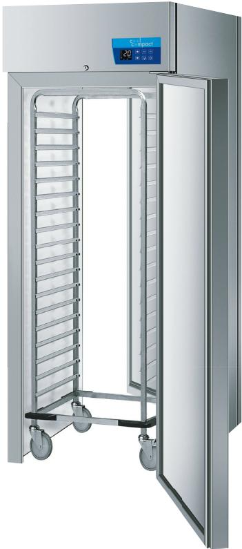
Durchfahr-Kühlschrank ohne Boden, mit CNS (1.4301 / AISI 304) Montagerahmen, innen und außen aus CNS (1.4301 / AISI 304), Hygieneausführung, Verdampfer außerhalb des Kühl-Innenraumes, mit Umluftkühlung.
