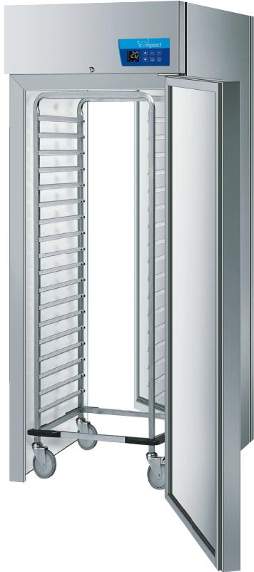
Durchfahr-Tiefkühlschrank ohne Boden, mit CNS (1.4301 / AISI 304) Montagerahmen, innen und außen aus CNS (1.4301 / AISI 304), Hygieneausführung, Verdampfer außerhalb des Kühl-Innenraumes, mit Umluftkühlung.
