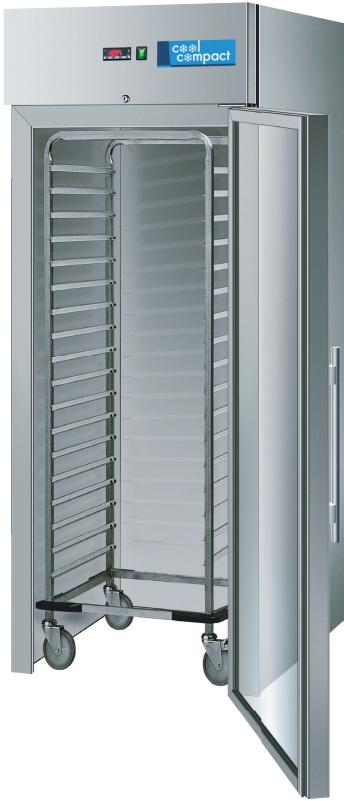
Einfahr-Wärmeschrank mit Glastüre, ohne Boden, mit CNS (1.4301 / AISI 304) Montagerahmen, innen und außen aus CNS (1.4301 / AISI 304), Hygieneausführung, Heizregister außerhalb des Innenraumes und elektronischer Regelung.
