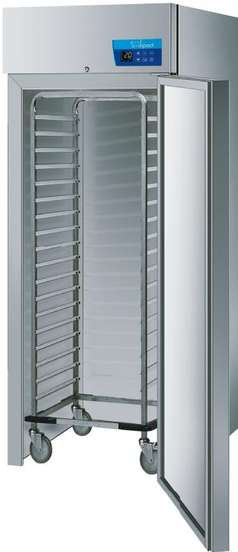
Einfahr-Kühlschrank ohne Boden, mit CNS (1.4301 / AISI 304) Montagerahmen, innen und außen aus CNS (1.4301 / AISI 304), Hygieneausführung, Verdampfer außerhalb des Kühl-Innenraumes, mit Umluftkühlung.
