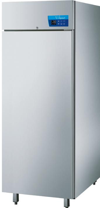
Fleischkülschrank, innen und außen aus CNS (1.4301 / AISI 304), Hygieneausführung, Verdampfer außerhalb des Kühl-Innenraumes, mit Umluftkühlung und selbstschließender Tür, abschließbar.
