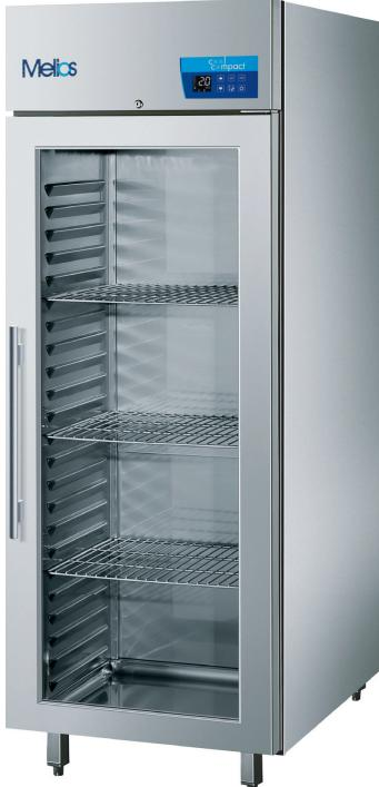
Tiefkühlschrank mit Glastüre, innen und außen aus CNS (1.4301 / AISI 304), Hygieneausführung, Verdampfer außerhalb des Kühl-Innenraumes, mit Umluftkühlung und selbstschließender Tür, abschließbar. Elektronische Regelung mit automatischem ECO-Modus, bedarfsgerechter Abtau- und Lüftersteuerung und beleuchtetem 3 Zoll LCD-Display. 90 mm Isolation, Innenraum mit Auflagerippen, frei von Stell- und Auflageschienen, tiefgezogene Bodenwanne mit Hygieradien.
