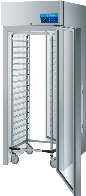
Durchfahr-Kühlschrank mit Glastüren, ohne Boden, mit CNS (1.4301 / AISI 304) Montagerahmen, innen und außen aus CNS (1.4301 / AISI 304), Hygieneausführung, Verdampfer außerhalb des Kühl-Innenraumes, mit Umluftkühlung.
