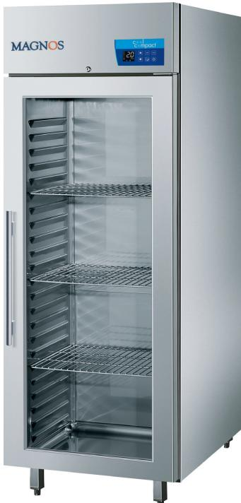
Tiefkühlschrank, innen und außen aus CNS (1.4301 / AISI 304), Hygieneausführung mit Umluftkühlung und selbstschließender Tür, abschließbar. Verdampfer ausserhalb des Kühlinnerraumes.
