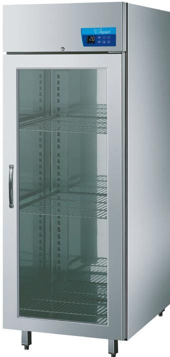
Tiefkühlschrank mit Glastüre, innen und außen aus CNS (1.4301 / AISI 304), Hygieneausführung, mit Umluftkühlung und selbstschließender Tür, abschließbar. Verdampfer außerhalb des Kühlinnenraumes. Elektronische Regelung mit automatischem ECO-Modus, bedarfsgerechter Abtau- und Lüftersteuerung und beleuchtetem 3 Zoll LCD-Display. Auch zur Verwendung von GN1/1 geeignet.
