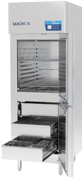
Tiefkühlschrank mit zwei Türen, und drei Zügen, innen und außen aus CNS (1.4301 / AISI 304), Hygieneausführung, Verdampfer außerhalb des Kühl-Innenraumes, mit Umluftkühlung und selbstschließender Tür, abschließbar. Elektronische Regelung mit automatischem ECO-Modus, bedarfsgerechter Abtau- und Lüftersteuerung und beleuchtetem 3 Zoll LCD-Display.
