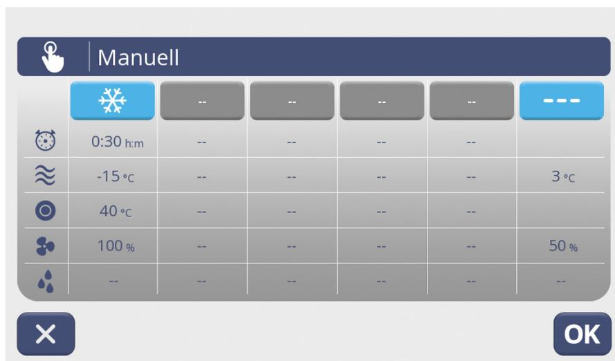
❄ Sowohl VINTOS als auch VINTOS+ bieten die Möglichkeit, manuelle, genau auf den Bedarf abgestimmte Programme zu erstellen. Die Handhabung ist denkbar einfach und ermöglicht es, Zeit, Temperatur und Lüfter-Geschwindigkeit individuell einzustellen.
