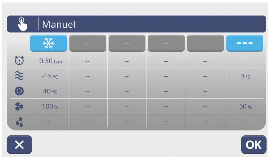
❄ Tant VINTOS que VINTOS + offrent la possibilité de créer manuellement des programmes adaptés à vos besoins. La gestion est très simple et vous permet de régler individuellement le temps, la température et la vitesse du ventilateur.
