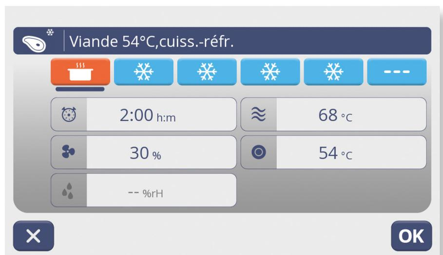
❄ Les programmes combinés offrent un maximum de confort et de gain de temps. Les aliments peuvent être cuits à basse température après le service, puis automati-
