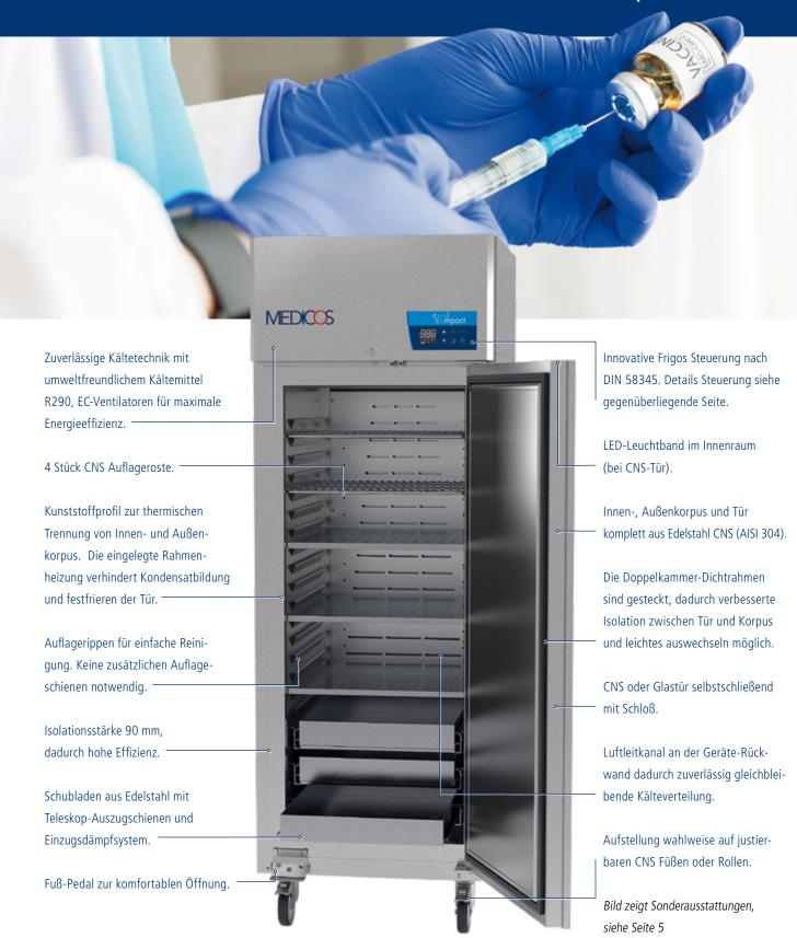
Medikamente müssen zuverlässig und sicher gelagert werden. Kühl- und Tiefkühlschränke der Baureihe MEDICOS entsprechen den hohen Anforderungen nach **DIN 58345**.
