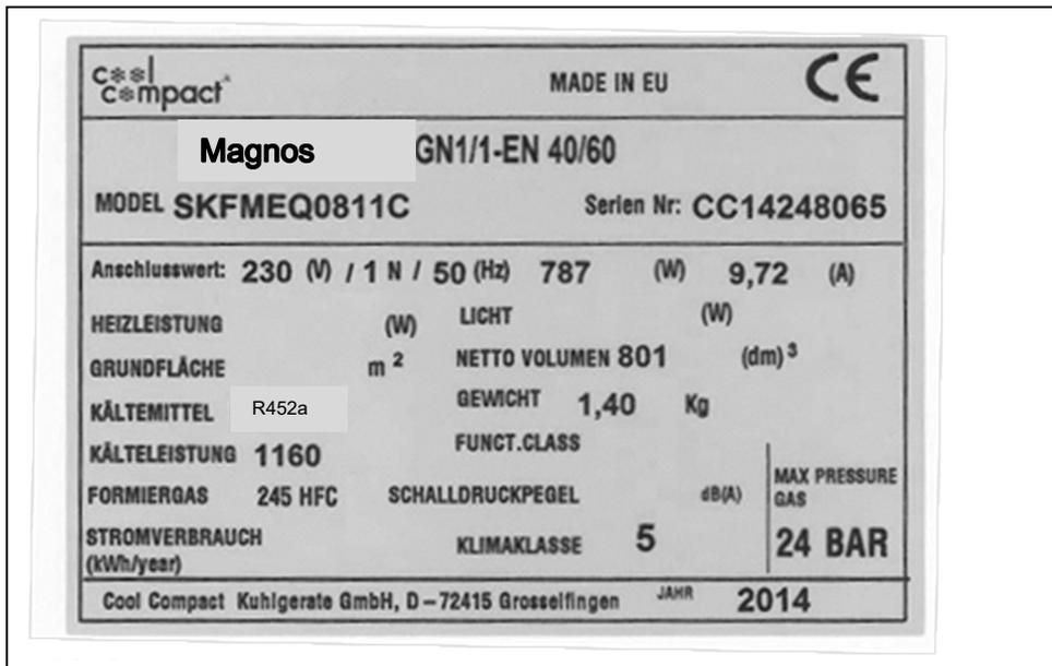
Figure 1 - Exemple de plaque d'identification fixée sur la machine.
